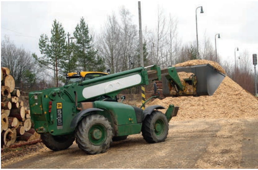
Abb 2 Radlader werden für den werksinternen Transport oder für das Verladen von Hackgut in den Terminals eingesetzt. Foto: Ulrich J. Wolfsmayr
