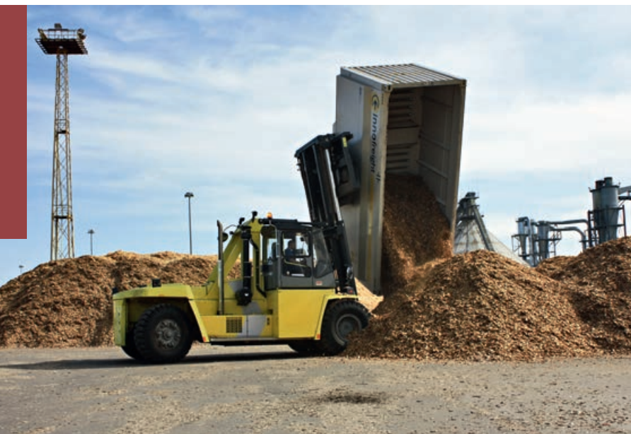
Abb 5 Drehentladestapler beim Entladen eines Wood Tainer. Foto: Innofreight
