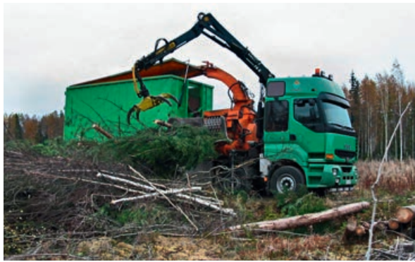
Abb 1 Ein Chipper-Chip-Truck im Einsatz. Foto: Raffaele Spinelli
