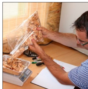
Probenahme und Bestimmung der Trockenmasse © Waldverband Steiermark
