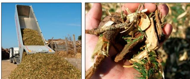
Entladung des Hackguts im Heizwerk und Hackgutprobe © WW Steiermark
